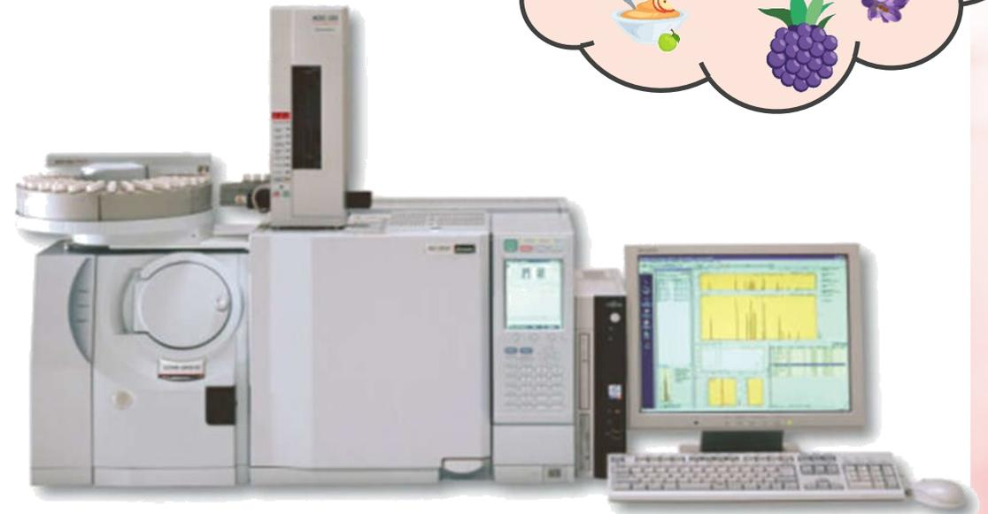
Appareil de chromatographie en phase gazeuse couplée à un spectromètre de masse
