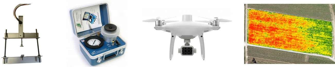
● Figure 1 Capteurs de contrainte hydrique mobilisés pour EnviProv. De gauche à droite : dendromètre, chambre à pression, drone équipé d'un capteur multispectral et exemple d'image générée.
